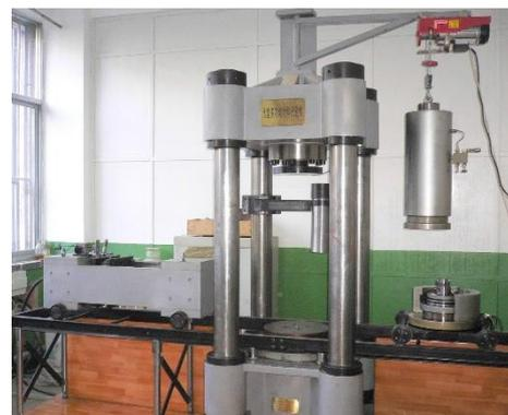
Fig. 3. WDT-1500 Rock Testing System.
